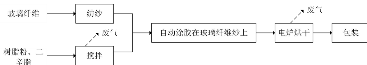
图 3-1 项目工艺流程及产污节点图
